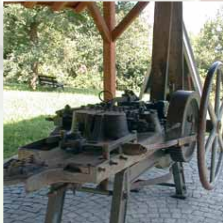
Starý stroj na výrobu hřebíků na „Humboldtwegu“
